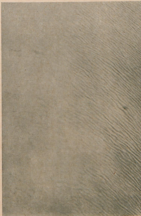
1. Durch fehlerhaften Aufbau des Anstrichs gerutschter Schleiflack
