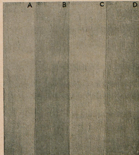
2. Probetafel mit 4 Lithoponeanstrichen. Die optische Wirkung der Anstriche ist je nach der Güte der Lithoponesorten eine andere.
