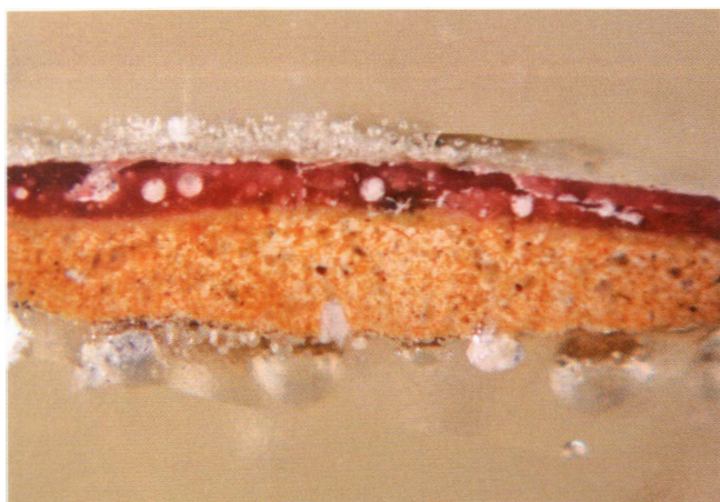
10. Ikonostas – naszlif szkliwa czerwonego. Iconostasis – polished cross-section of red glaze.
