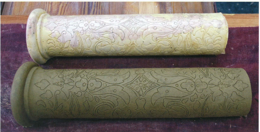
29. Pracownia ceramiki. Wyciskanie kafła w formie silikonowo-gipsowej. Ceramic workshop. Making an impression of a tile in a silicon-plaster mould.
