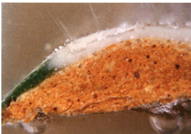
13. Ikonostas – naszlif szkliwa zielonego i białego, stopionych ze sobą na granicy. Widoczna warstwa barwnego szkliwa bezpośrednio na czerepie, bez angoby. Iconostasis – polished cross-section of combined green and white glaze. Visible layer of coloured glaze directly on the shard, without the engobe.
