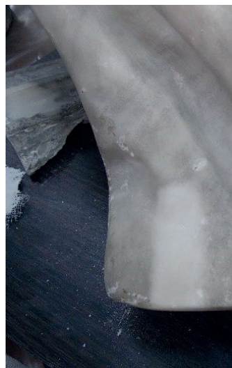
25. Wyniki oczyszczania za pomocą roztworu pankreatyny Result of cleaning with a Pancreatin solution
