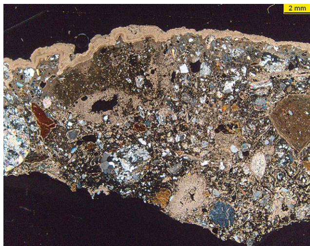
2 Dünnschliff des opus caementicium -Kerns, Stufenunterbau der Cavea (P12/2010)
