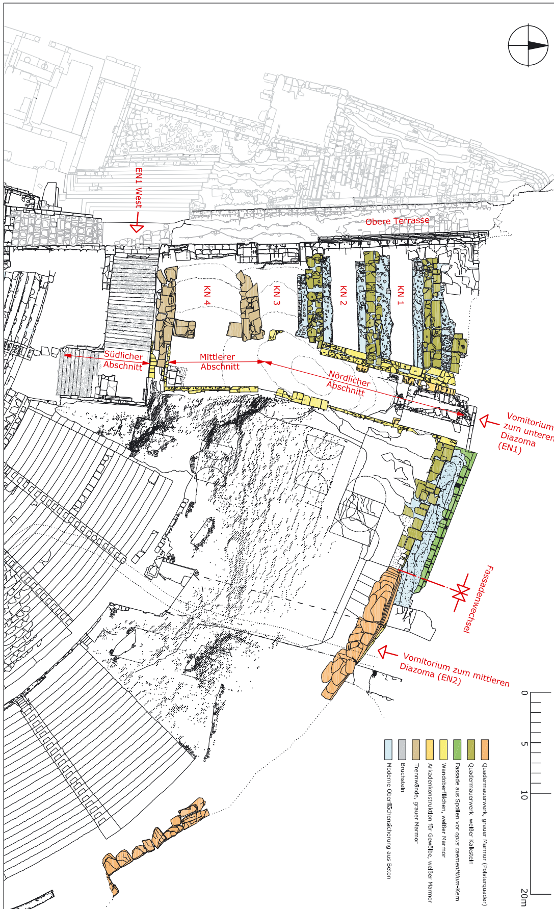
Textabb. 19: Grundriss des Theater-Nordflügels (Ausschnitt) mit Materialkartierung (Bestandsplan)
