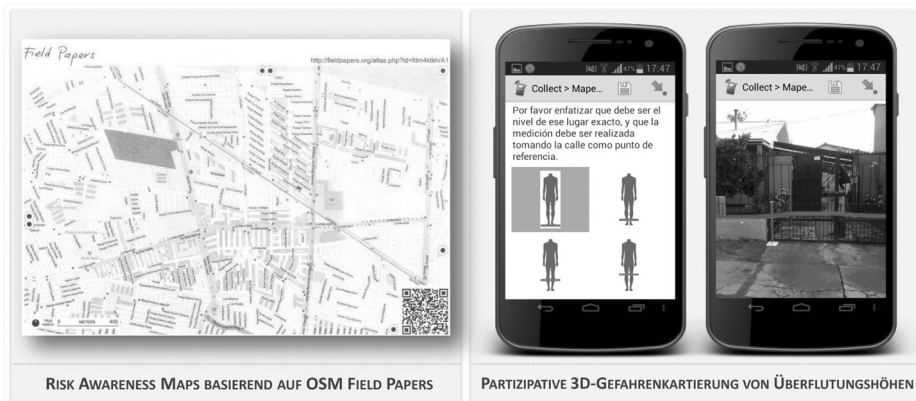
Abb. 1: Partizipative Gefahrenkartierung (durch die lokale Bevölkerung) im Untersuchungsgebiet Quilicura, Santiago de Chile, am Beispiel von Urban Floods (Mai 2015). Links: Von Überschwemmung betroffene Straßen sind markiert im OSM Field Paper, rechts: Erfassung von Überflutungshöhen mittels Smartphone Applikation.
