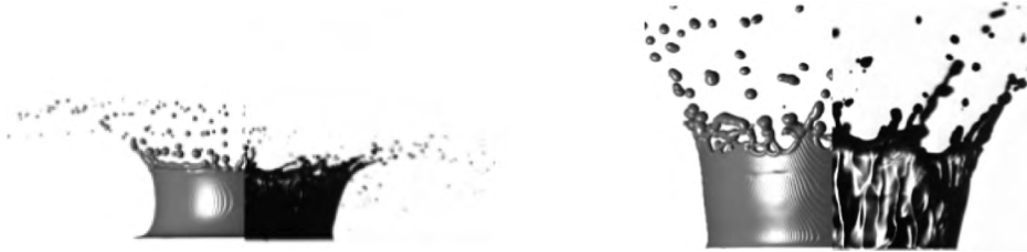
Abb. 1: Kronenbildung beim Auftreffen eines Tropfens auf einen dünnen Flüssigkeitsfilm
